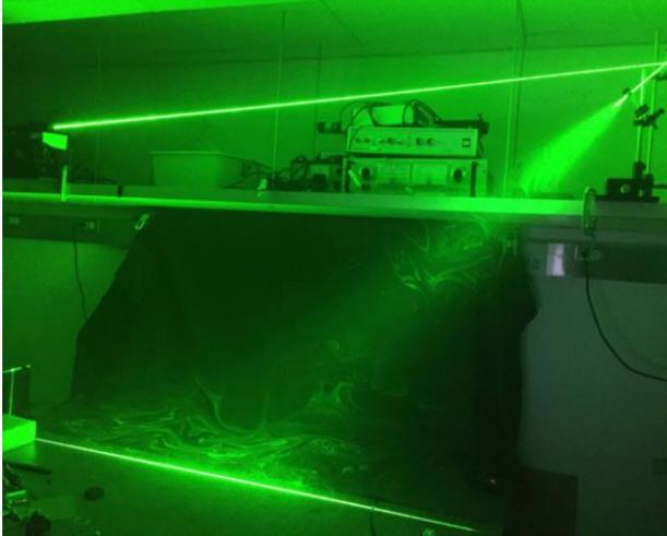
El COVID-19 ocasionó que se realizaran nuevos experimentos para determinar la transmisión a través del aire, como esta lámina láser para iluminar las gotas de saliva.
