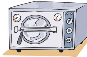
Para lograr la desinfección se colocan las bolsas rojas resistentes al calor húmedo y bien cerradas, en el autoclave a 121° centígrados con 15 libras de presión durante 30 minutos, en este caso las cajas de petri desechables y otros dispositivos de plástico utilizados en el laboratorio quedan "irreconocibles"<sup>2</sup>.
